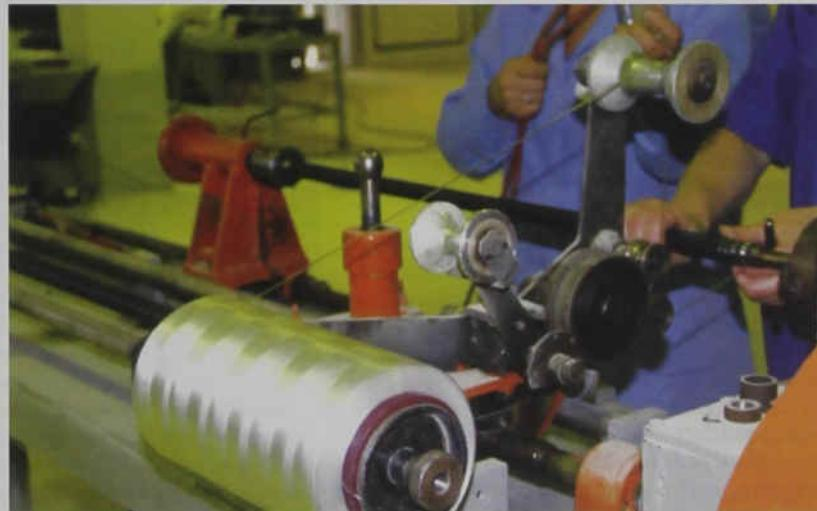
пластиковые трубы длиной до 1700 мм с внутренним диаметром от 4 до 80 мм и наружным диаметром от 5,5 до 100 мм, с различной толщиной стенок и углом армирования стекловолокна в зависимости от предъявляемых к изделию требований.
