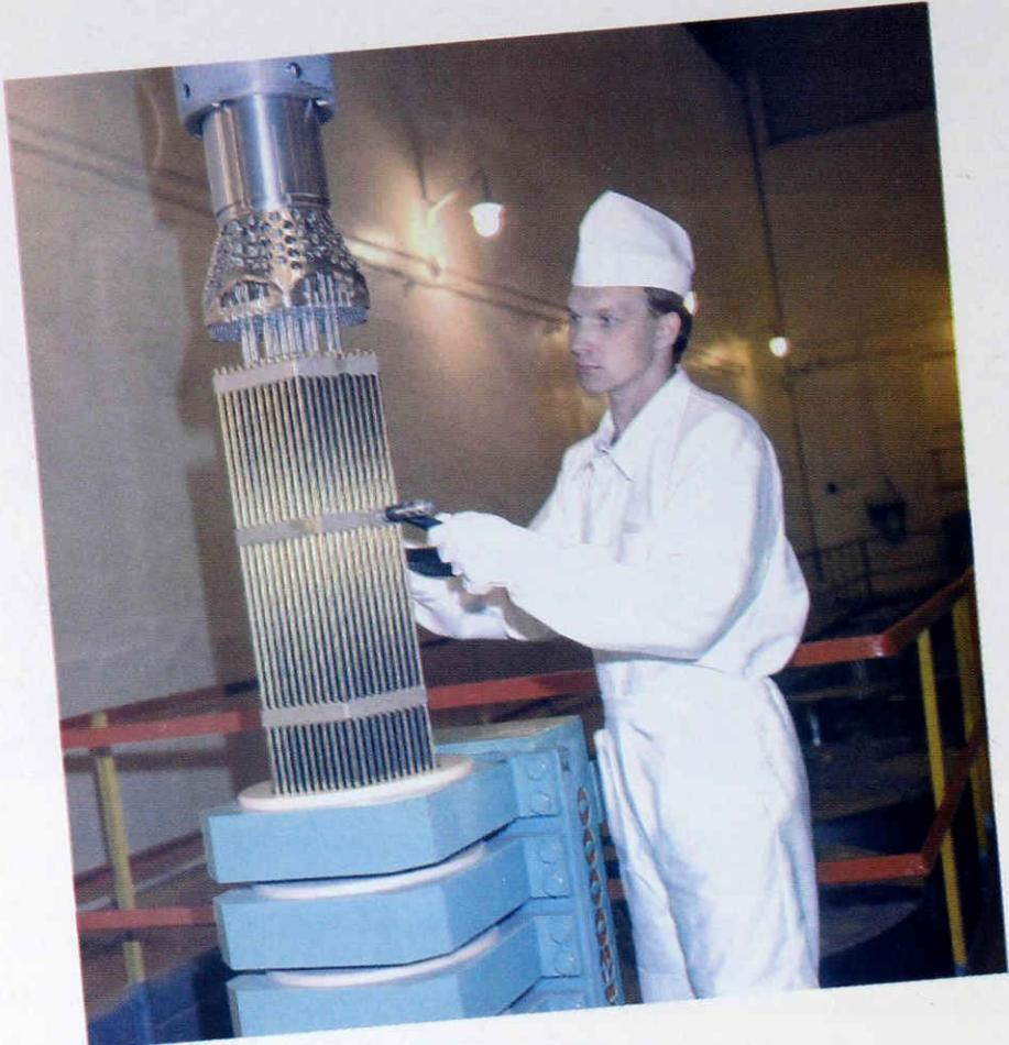
**Каждая тепловыделяющая сборка проходит перед загрузкой в реактор тщательный контроль**
